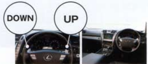
強いていえば AMG のパドルシフトと雰囲気が似ている SKIPPER のパドルシフター。完成度の高いインテリアのイメージを損なわない。ステアリングに向かって右のパドルがシフトアップ、左のパドルがシフトダウン。
